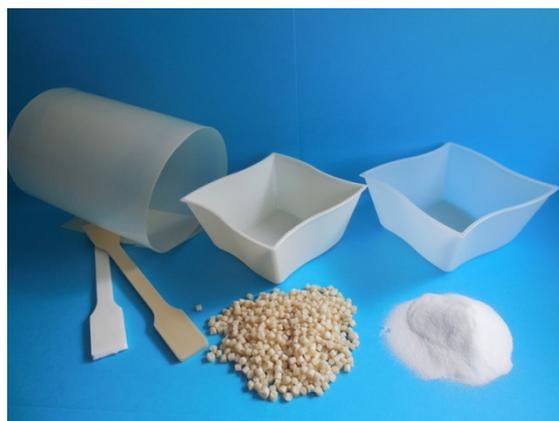
Au-delà des débouchés qu'offre le PHA (polyhydroxyalcanoate) comme alternative à la fabrication de sacs et vaisselles jetables, ce matériau ouvre des perspectives plus larges, dans le domaine de l'impression 3D ou du biomédical.
