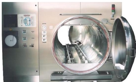
Par ailleurs, l'autoclave de SteriFlow sera équipé d'un système de supervision permettant la gestion du suivi opérationnel, la gestion de l'énergie consommée et la maintenance.
