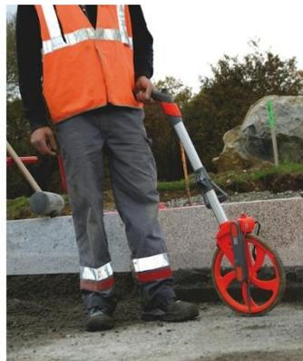
Un odomètre pour relever les largeurs et longueurs des différents espaces (utilisateur, embarquement, cheminement, chaussée, distance PA-Traversée, distance PA-carrefour, distance PA-ralentisseurs)
