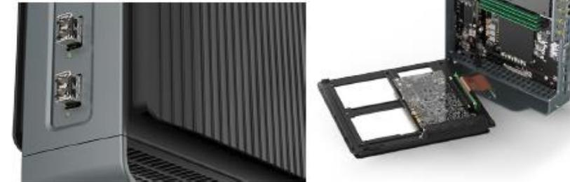
Airtop 3 avec option multi disques et connecteurs fibre
